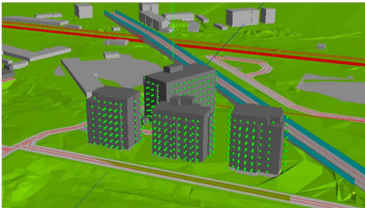
Rys. 5.1 Render 3D modelu wykonanego w programie SoundPLAN
